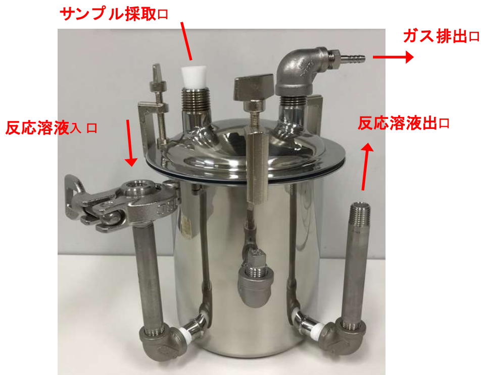
図5 ガス放出部の製作状況
